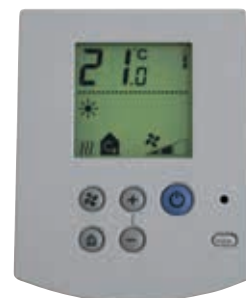
Het bedieningspaneel is inclusief ruimtethermostaat en weektimer.
